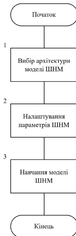
Рисунок 1. Схема етапів конструювання моделей ШНМ
