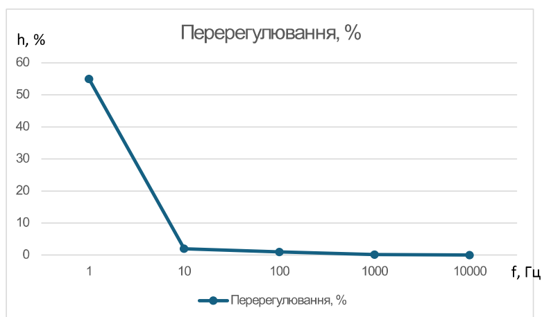
Рисунок 7. Графік залежності перегулювання від частоти ШІМ
