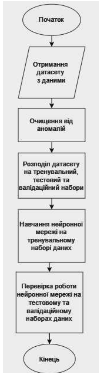
Рисунок 2. Блок-схема алгоритму навчання нейронної мережі
