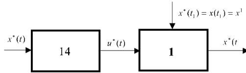
Рис. 1 – Разомкнутая структура генерации оптимального вектора переменных состояния
