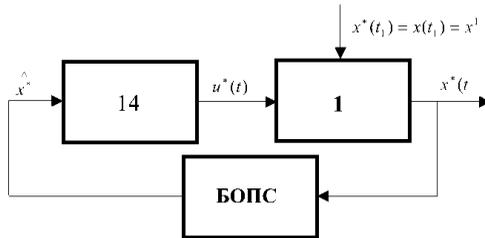
Рис. 2 – Замкнутая структура генерации оптимального вектора переменных состояния
