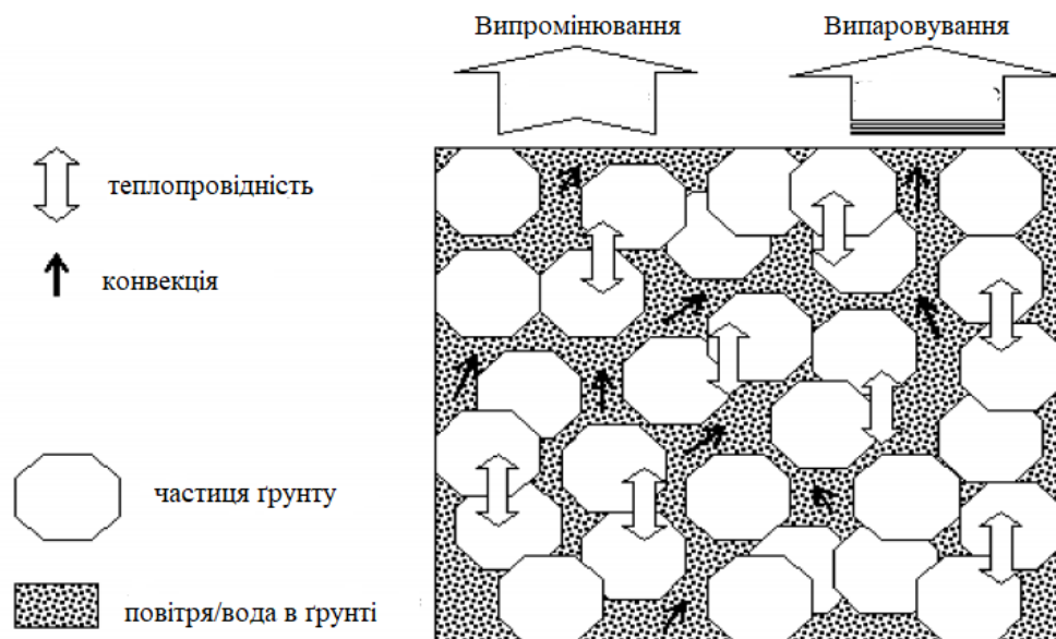
Рисунок 1. Основні механізми теплообміну в ґрунті
