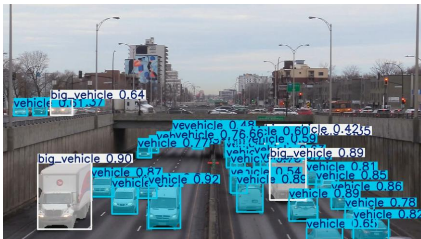
Рисунок 5. Приклад одночасного визначення обмежувальних рамок та масок сегментації моделлю, яка розроблена
